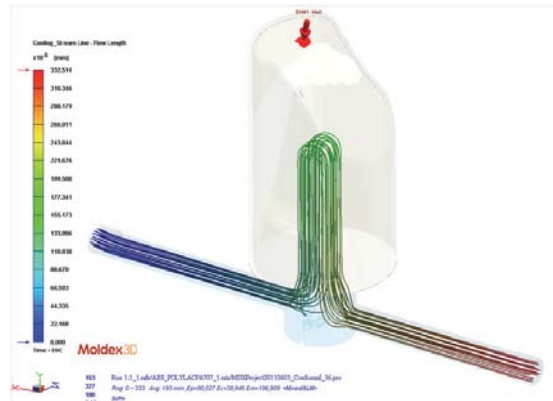
그림 2. 배플냉각채널 내부의 유선(stream lines)
