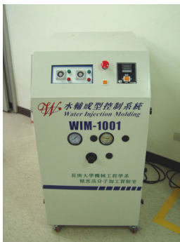
圖一 液體輔助射出成形系統
